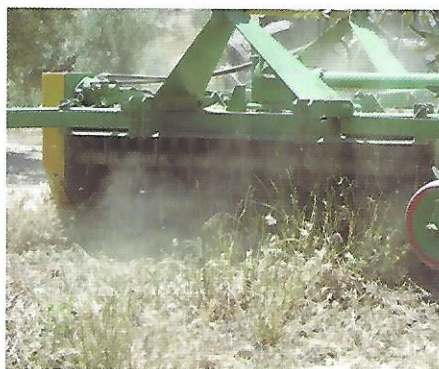
Foto 7. Sistema de autoalimentación de picadora de martillos accionada por la toma de fuerza delantera del tractor.
