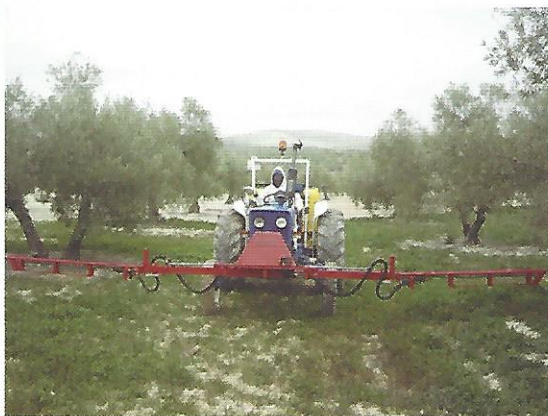
Foto 5 (izda). Barra de tratamiento sectorizada en tres tramos (izquierda) y boquilla terminal excéntrica metálica (derecha) para realizar tratamientos de hasta 1,5 m de distancia. Foto 6 (dcha). Rastrillo hilerador para restos de poda utilizado en olivar.
