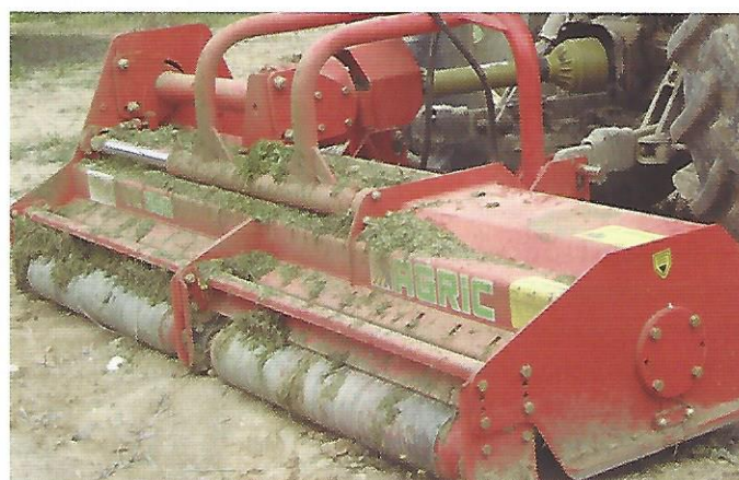
Foto 3 (izda). Cubierta vegetal en olivar con banda de ensemillado. Foto 4 (dcha). Desbrozadora de martillos con cilindro hidráulico para desplazamiento y trabajo bajo copa.
