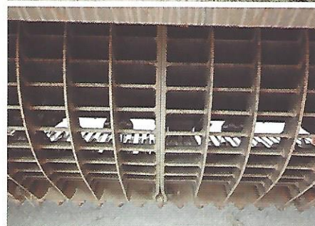
Foto 8. Picadora de martillos-criba (arriba) y detalle del sistema de picado con martillo giratorio y sistema de criba para evitar salida de restos de gran tamaño (abajo).
